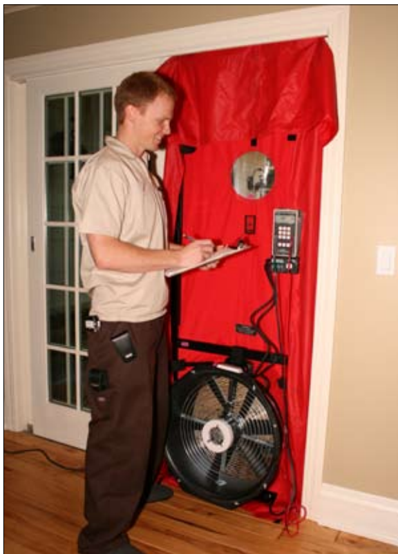
EA51 Blower Door Test Setup
